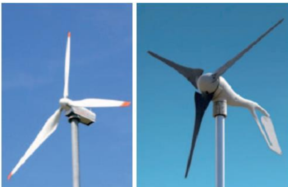
Rysunek 8 Turbiny o poziomej osi obrotu
